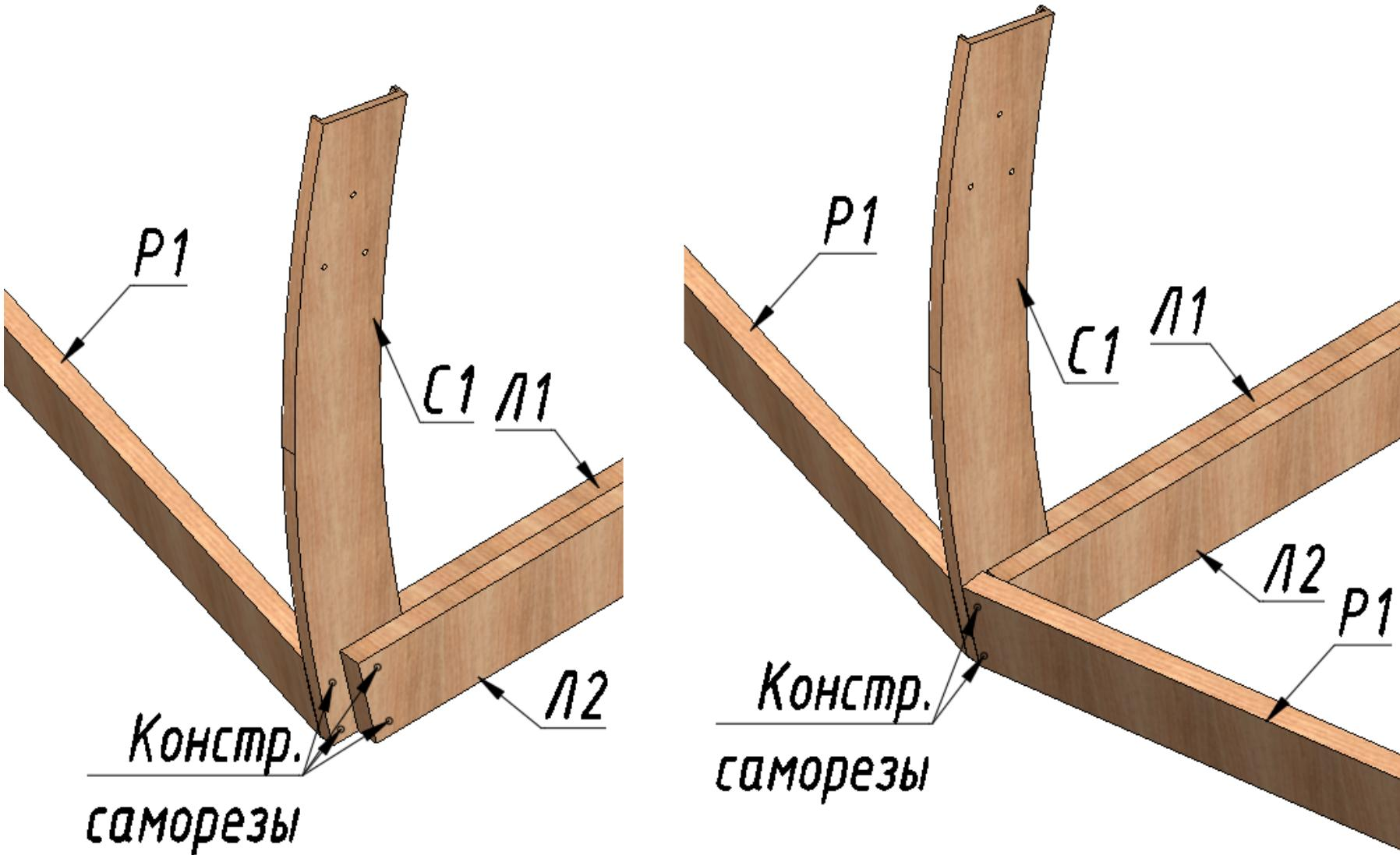
В комплектации без лаг пола, стойки С1 следует скреплять с распорками Р1 с помощью саморезов (в комплект поставки не входят). С одного края саморезы заходят в торец, с другого края вкось. Перед закручиванием самореза, необходимо по месту засверлить детали из фанеры.
