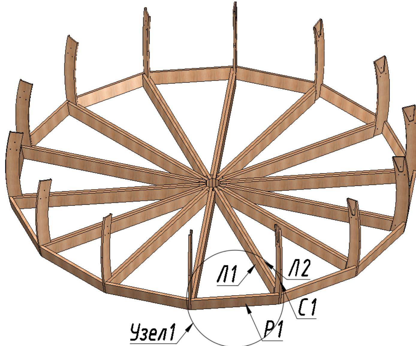
В комплектации с лагами пола, стойки С1 следует скреплять с лагами пола и распорками Р1 с помощью конструкционных саморезов, как показано на схеме.
